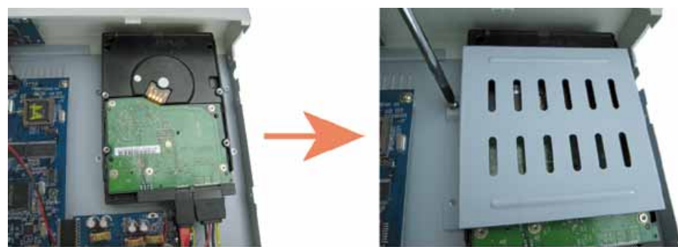
Étape 4 : Placez le HDD et remplacez le montant
