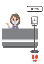
本裝置不得安裝在冷 / 熱風出風口、陽光直射與明顯空氣流動處·因室溫不穩定會影響溫度偵測的 正確性。
